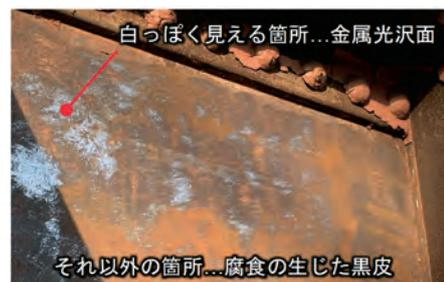
写真-3 切り出し部材の素地調整後の外観
