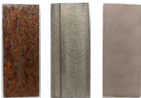
処理前腐食鋼材 レーザー処理後 ブラスト処理後
