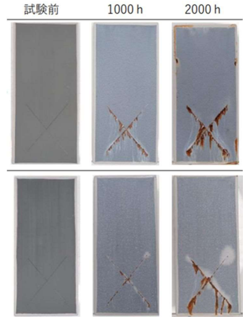
図 7 素地調整後のジंकリッチ単層に対する中性塩水噴霧による耐久性試験結果 (上段レーザー、下段ブラスト) 9)
